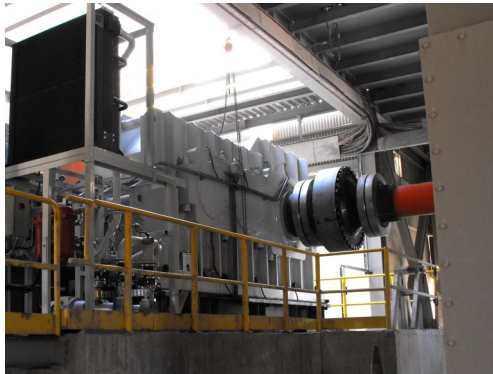
گیربکس استفاده شده در کوره دوار در کارخانه سیمان
